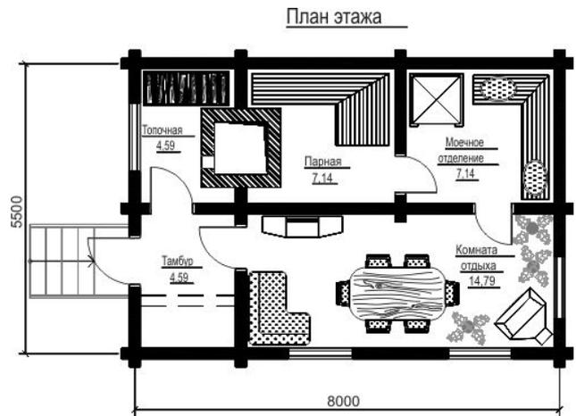
1. Диаметр стенового материала - 200мм
