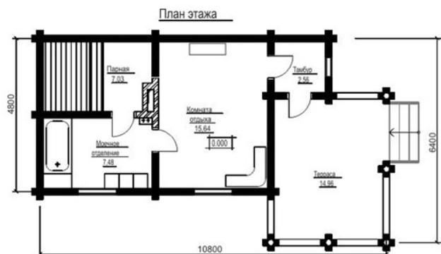
1. Диаметр стенового материала - 200мм
