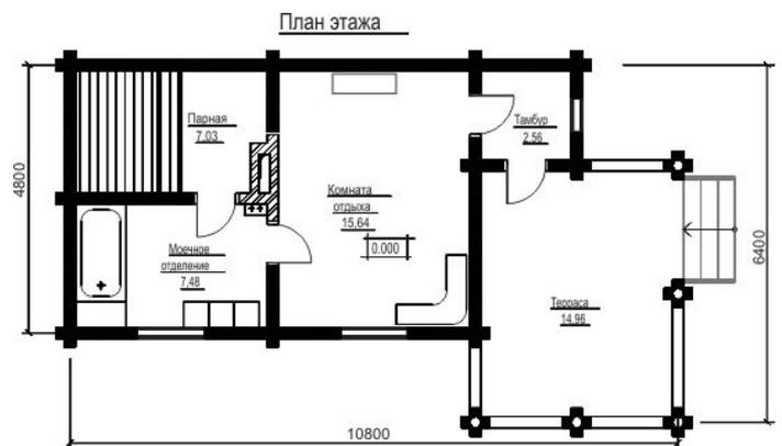
1. Диаметр стенового материала - 200мм
