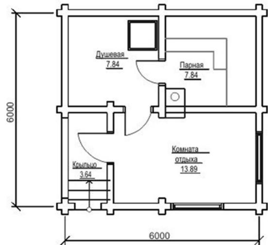
1. Диаметр стенового материала - 200мм
